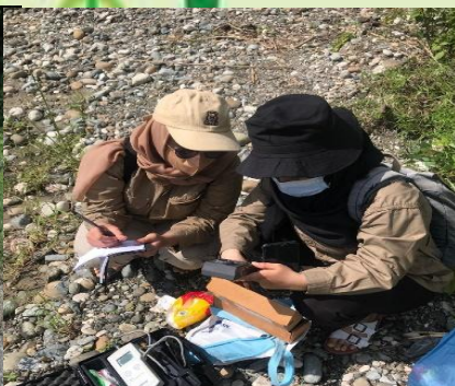
Pengambilan dan Pengujian Parameter Lapangan Sampel Air Permukaan (Sungai) di Sungai Kayowa, Kec. Batui, Kab. Banggai, Sulawesi Tengah
