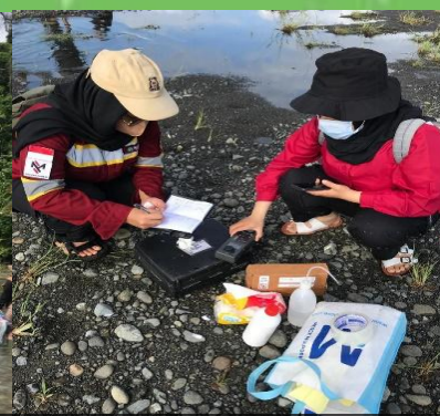
Pengambilan dan Pengujian Parameter Lapangan Sampel Air Permukaan (Sungai) di Sungai Minahaki, Kec. Toili, Kab. Banggai, Sulawesi Tengah
